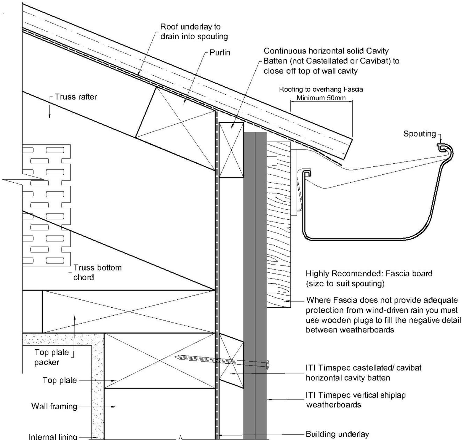
**VC 602 Roof/ Wall Top Plate – No Soffit**
