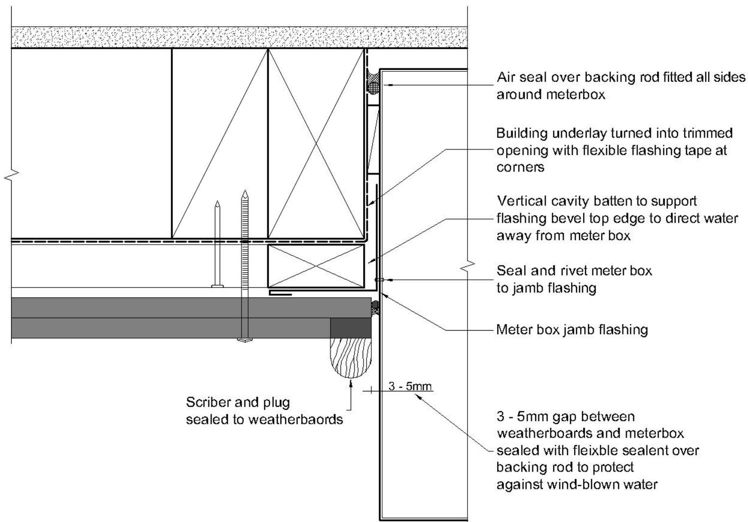
**FIGURE 13. 23 RC 803 METER BOX SILL**
