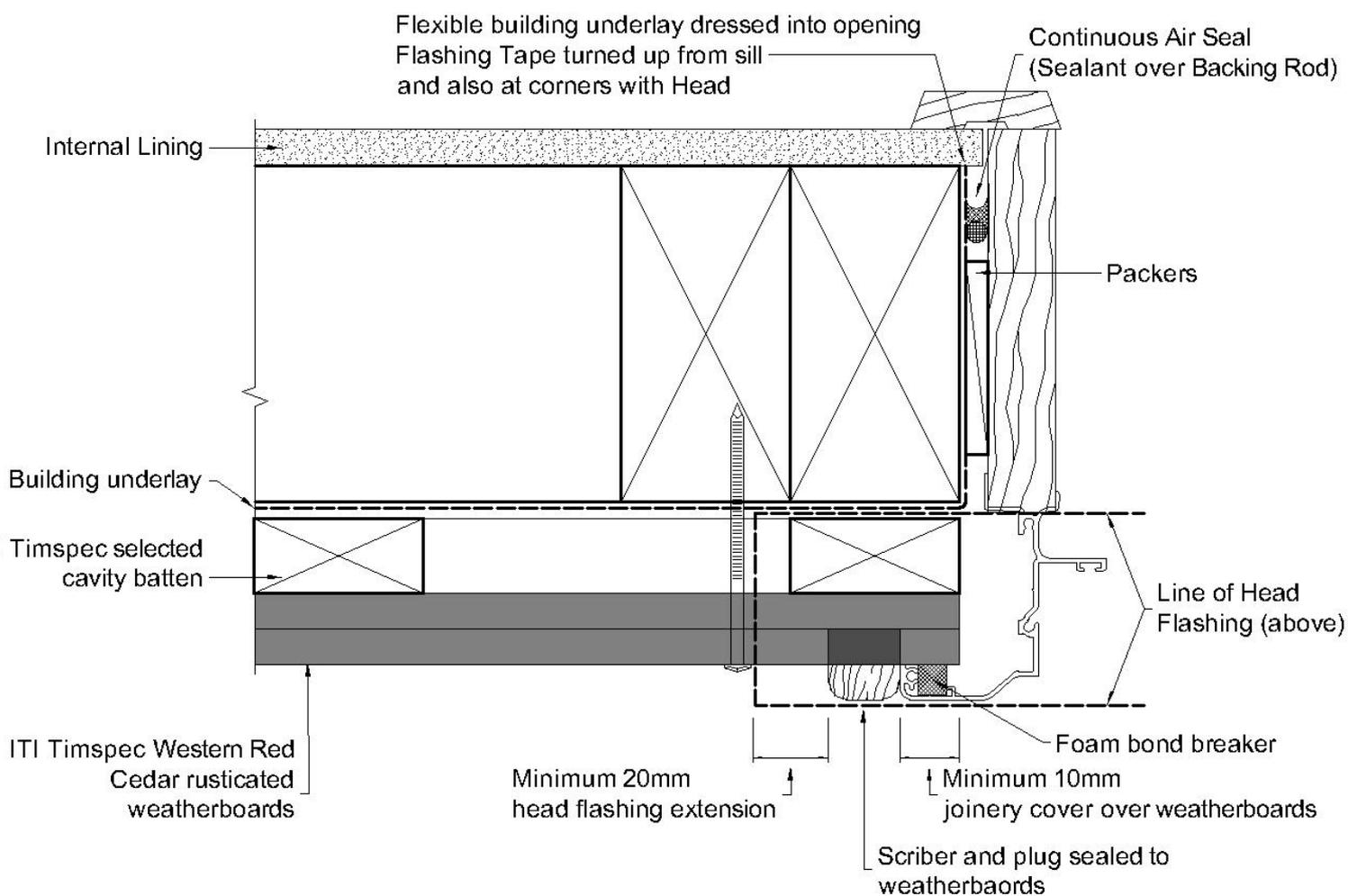
**FIGURE 13. 5 RC 203 WINDOW SILL – ALUMINIUM JOINERY**
