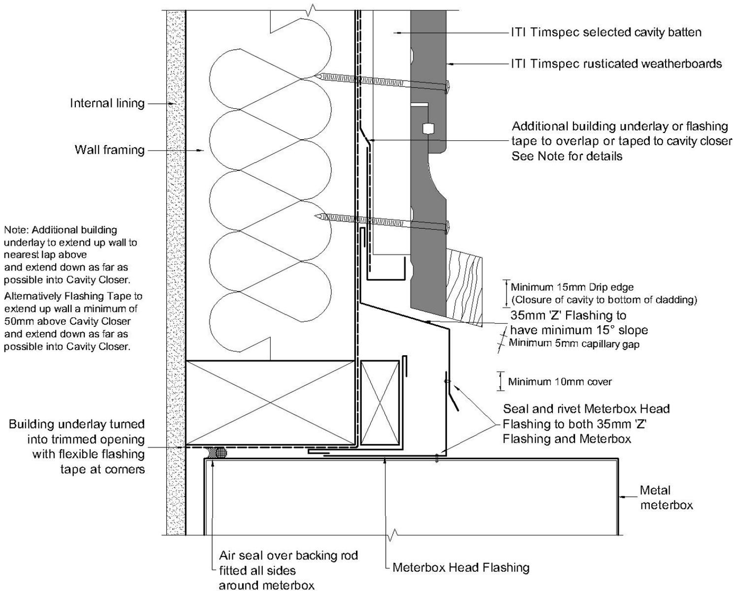
**FIGURE 13. 22 RC 802 METER BOX JAMB**
