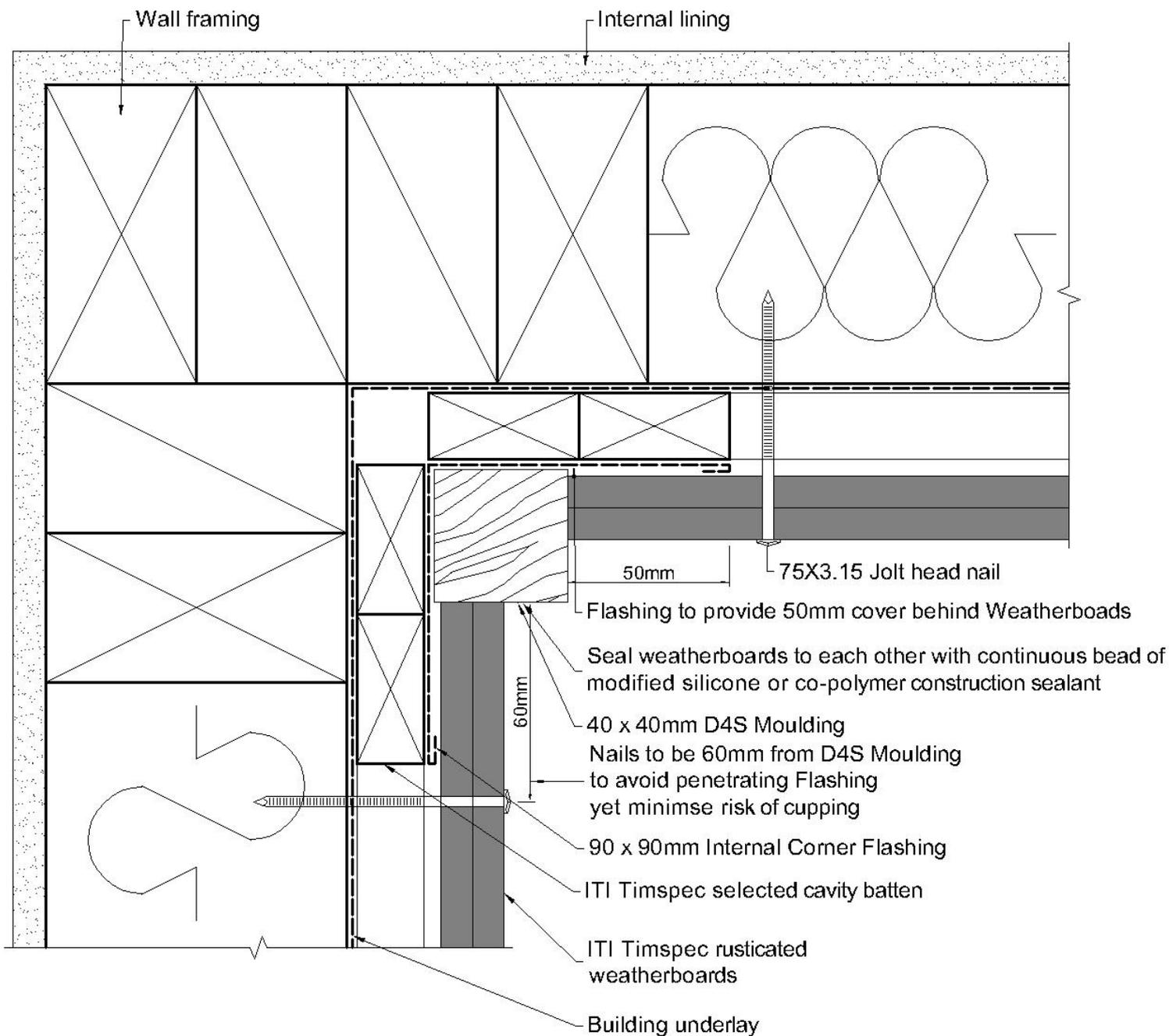
**FIGURE 13. 8 RC 302 INTERNAL CORNER – BUTTED**
