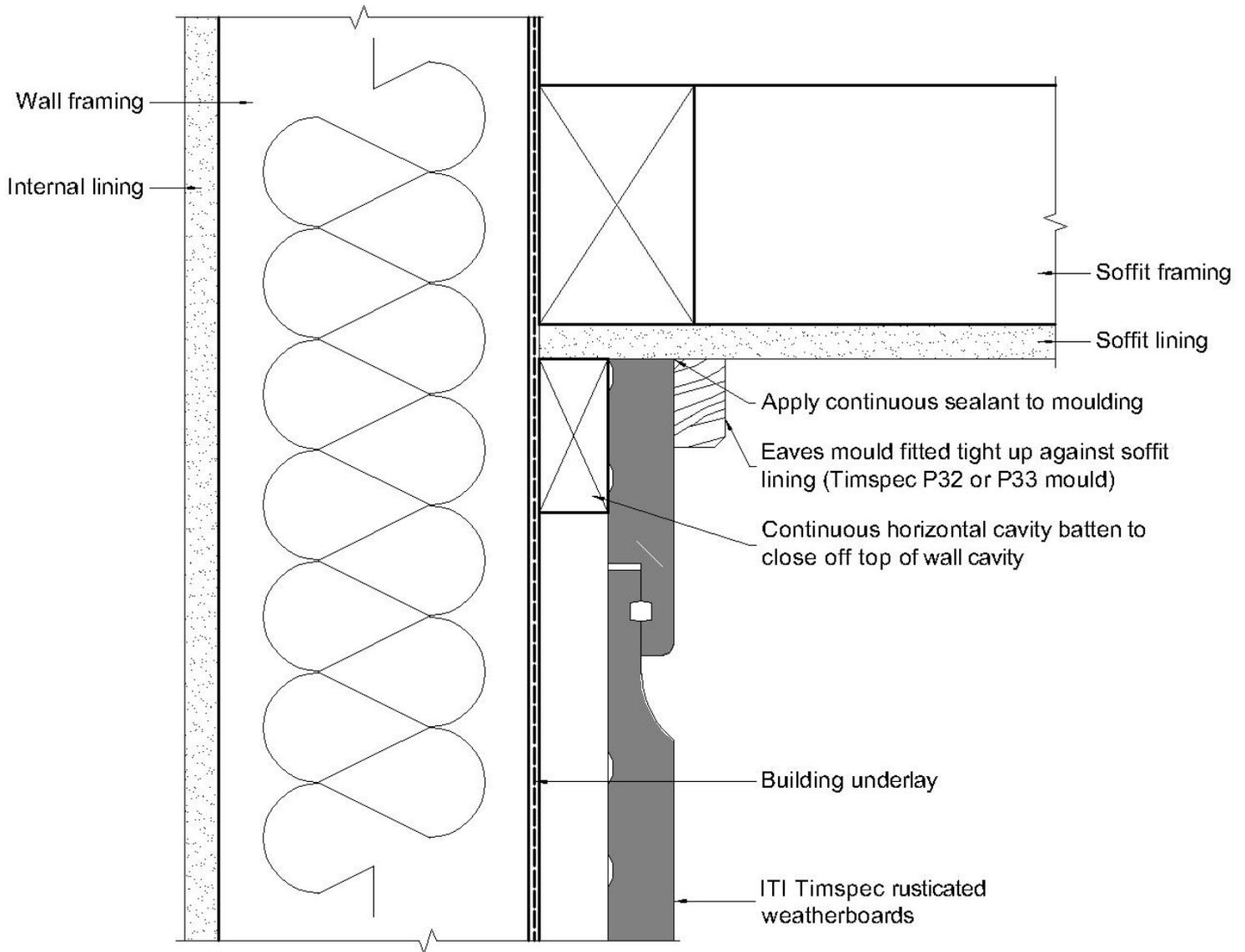
**FIGURE 13. 18 RC 602 ROOF/ WALL TOP PLATE - NO SOFFIT**
